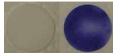
Fig. 4 拡散フィルターへのPTIOの浸透 白色拡散フィルターがPTIOの浸透によって、青色へと変色。
